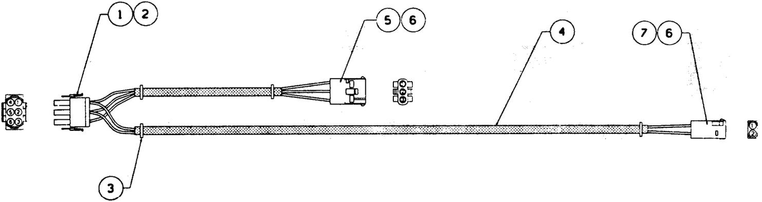
NOTE: THIS HARNESS CONNECTS TO DOOR INTERLOCK SWITCH HARNESS, DOOR SOLENOID INTERLOCK HARNESS AND POWER BOX.
