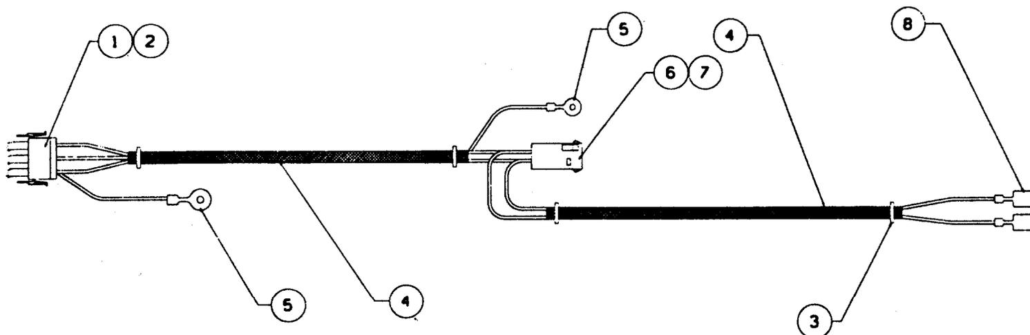
NOTE: THIS HARNESS CONNECTS TO POWER BOX ASSEMBLY. HEAT STRIP AND BLOWER MOTOR WHICH IS LOCATED ON THE SHADOW BOX ASSEMBLY/SERVICE DOOR.
