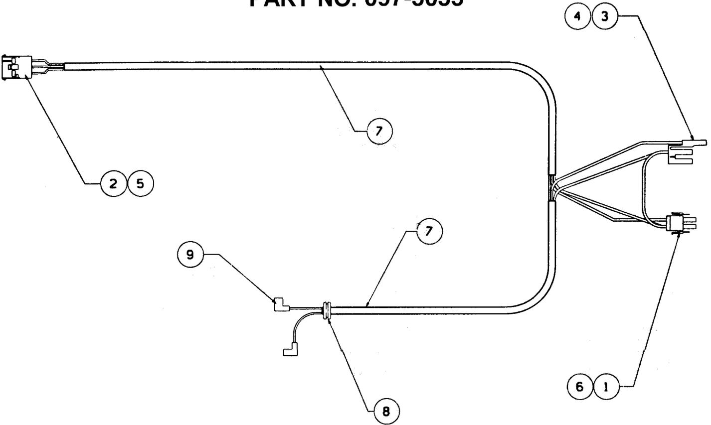
NOTE: THIS HARNESS CONNECTS TO THE SHOPPER MOTOR AND THE DOOR INTERLOCK SWITCH HARNESS.
